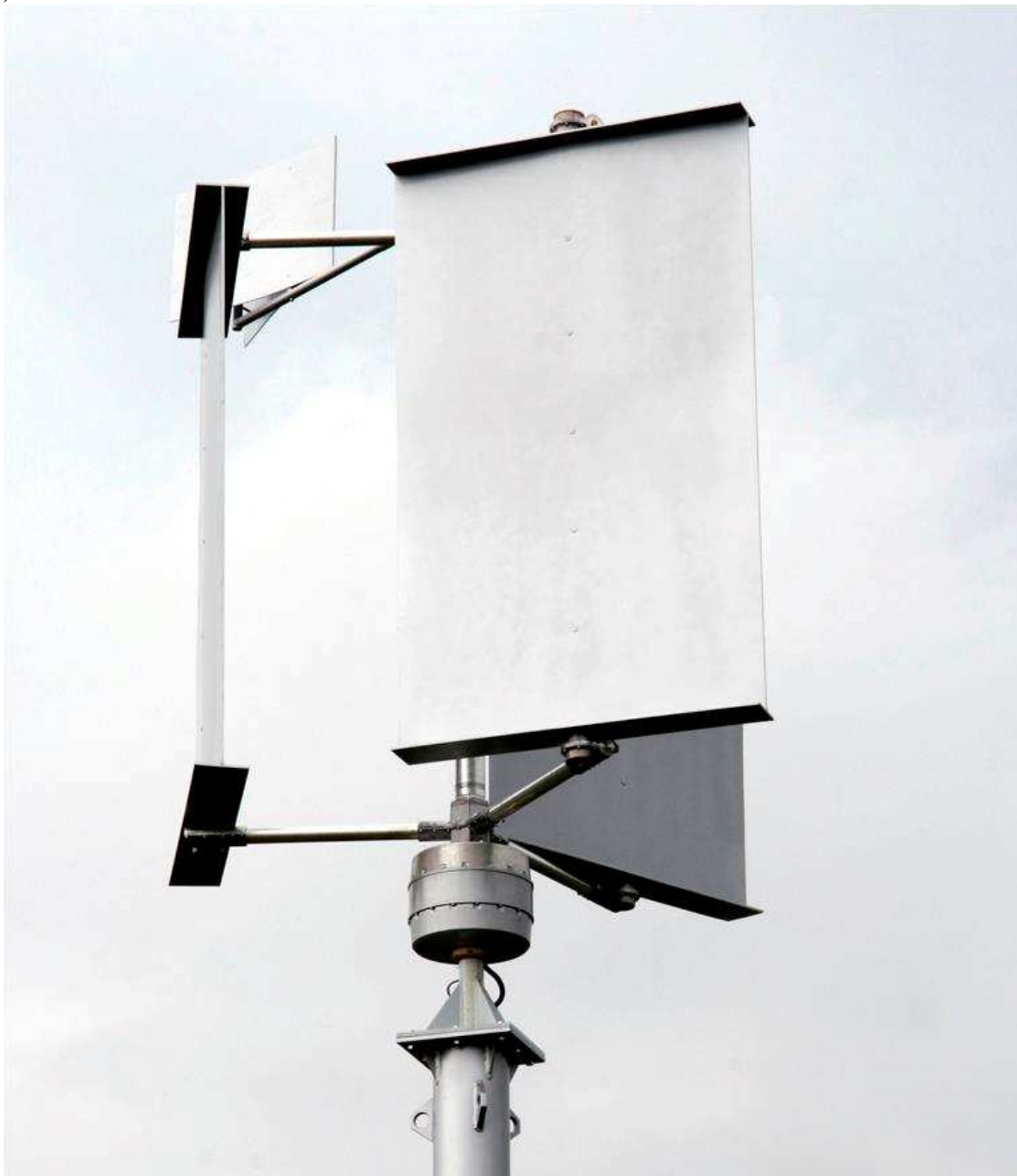
Detail rotoru větrné elektrárny SIMETI 5 kWp. (zdroj: www.genetop.cz )
