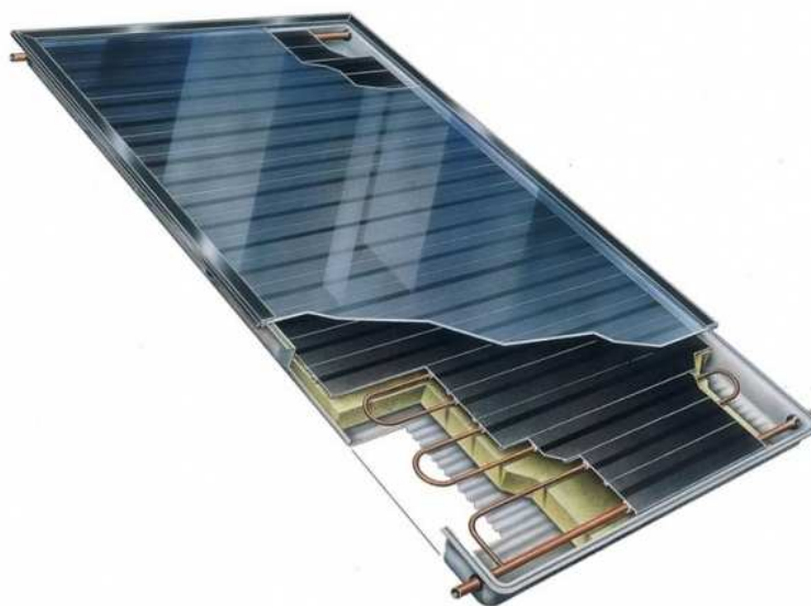
Obr. 4. Schematický řez solárním kolektorem [8]
