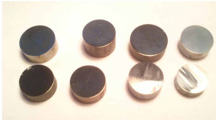
Obr. 15-1 Vzorky pro test tvrdosti HV
