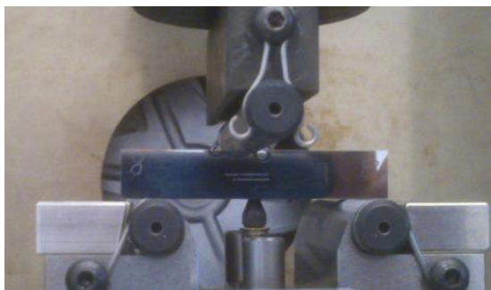
Obr. 20-5 Dolomení vzorku tříbodovým ohybem
