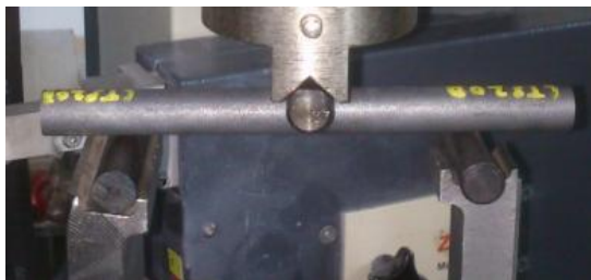
Obr. 22-4 Umístění vzorků při zkoušce tříbodovým ohybem
