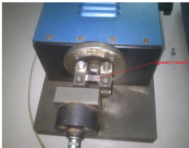
Obr. 20-3 Rezonanční stroj RUMUL s upnutým vzorkem
