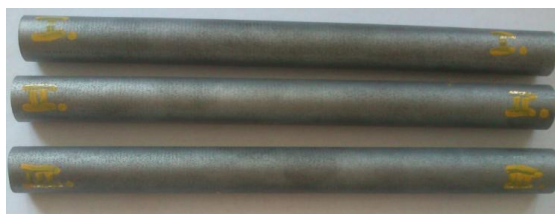
Obr. 22-3 Vzorky pro třibodový ohyb - v neopracovaném stavu
