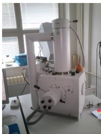
Obr. 14-3 Řádkovací elektronový mikroskop od firmy philips
