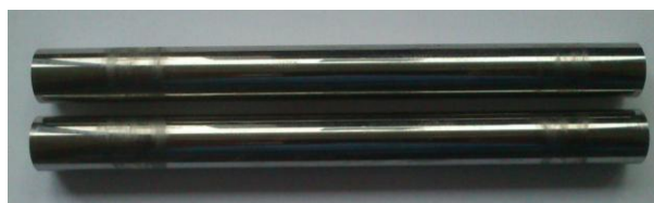
Obr. 22-2 Vzorky pro třibodový ohyb - leštěné
