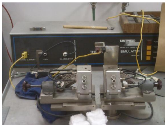
Obr. 14-4 Thermal cycle simulator od firmy od SMITWELD
