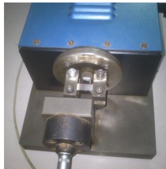
Obr. 14-7 Rezonanční stroj RUMUL
