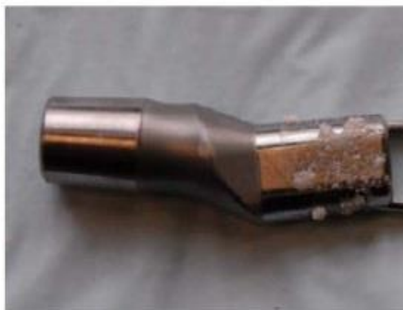
Obrázek 6 – Ukázka komponentu modulárního implantátu napadeného vibrační korozi
