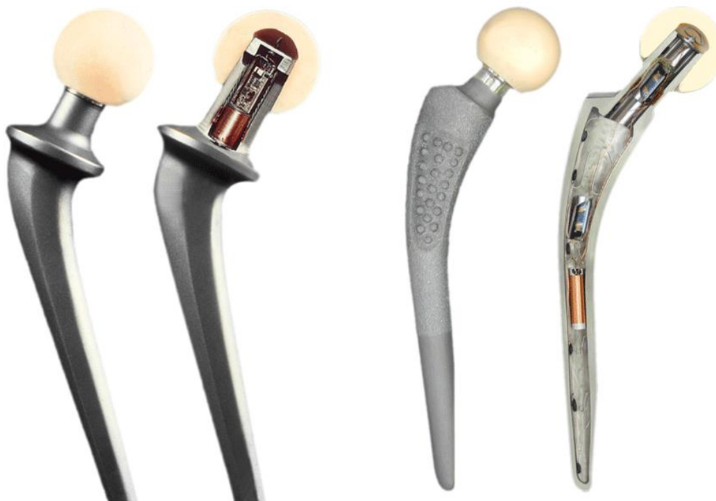
Obrázek 15 - implantáty použité pro experimentální měření napětí (sil) na náhradě kyčelního kloubu, implantát vpravo umožňuje i měření teploty (21)
