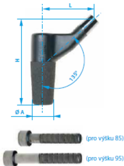
Obrázek 9 - Hlavní rozměry proximálního segmentu (16)
