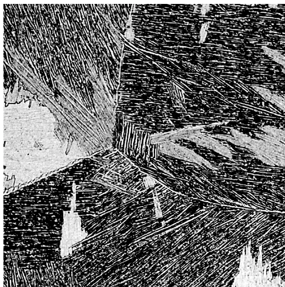
Obrázek 11 – Alfa - beta globulární slitina TiAl_6V_4 , vzorek pocházející z tyče o průměru 38 mm
