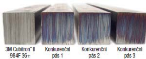
Obrázek 53: Porovnání tepelného ovlivnění obrobku [22]
