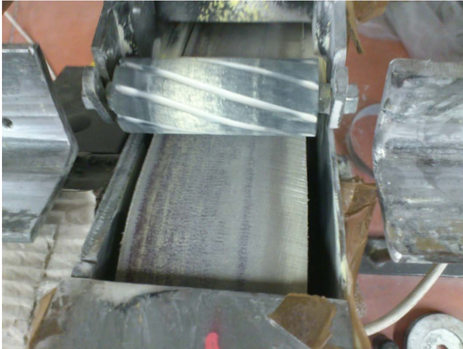
Obrázek 60: Opotřebený brusný pás Trizact
