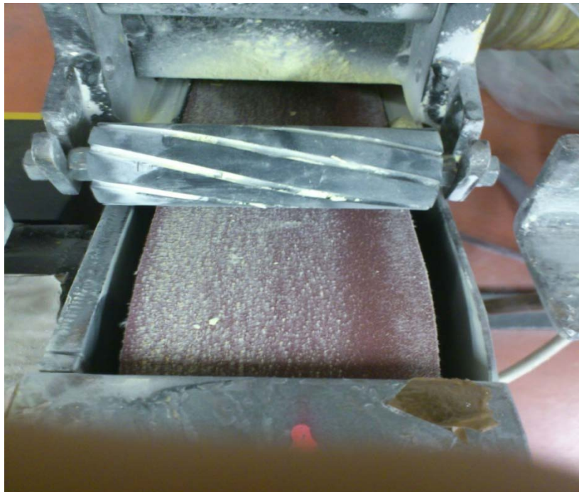
Obrázek 61: Opotřebení brusného pásu SX373 P240
