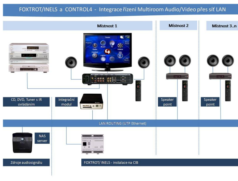
Obrázek 3-2 - Zapojení multimediálního systému k centrální jednotce (převzato z [10])
