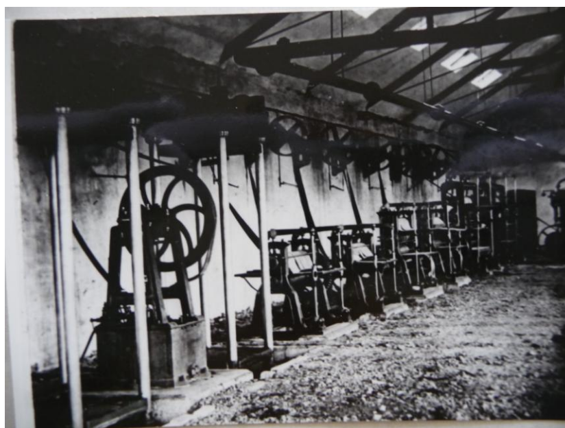
Příloha A 10: Fotografie lisů a kalandrů poháněných parním strojem (v pozadí snímku) z let 1873-1878. Fotografie Josefa Böttingra, který působil v Plzni v letech 1873-1882.
