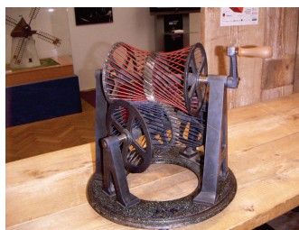
Obrázek 2.29: Soukolí hypoidního převodu a jeho detail
