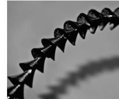
Obrázek 3.10: Kovová špona po obrábění
