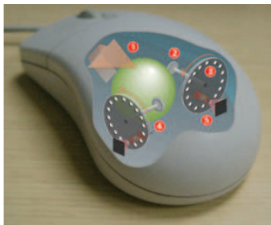
Obrázek 2.7: Schéma kuličkové myši
